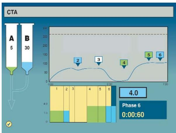
Графическое отображение давления при выполнении инъекции в реальном времени
